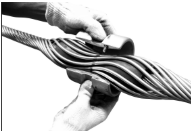
8. Posicione as sapatas internas sobre o conjunto de varetas preformadas.
