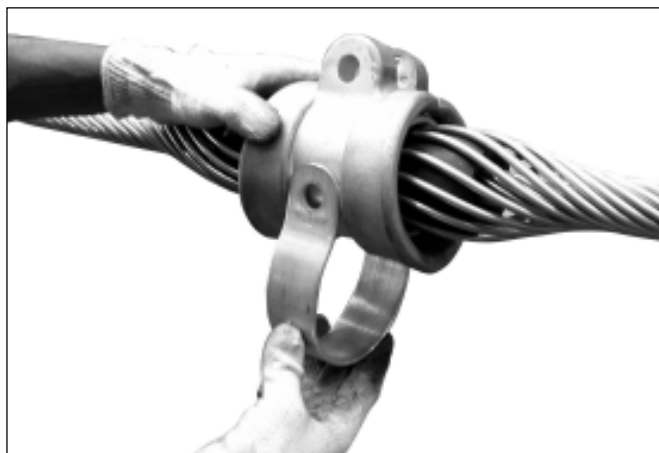
11. Insira a abraçadeira de alumínio envolvendo o conjunto. Afaste as orelhas das sapatas e posicione novamente a abraçadeira afim de facilitar o alinhamento e colocação do parafuso.
