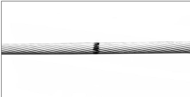
**1.** Señale la posición correcta de la grapa sobre el cable conductor utilizando cinta ó tinta. Deje espacio libre para trabajar sobre el cable.
