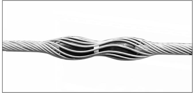
**6.** Utilizando ambas manos, enrolle las varillas de un extremo. Gire simultáneamente todos los extremos de las varillas de modo que ellas se posicionen.
