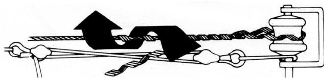
**3.** Introduza a segunda perna da Alça envolvendo a roldana e aplique-a sobre a cordoalha, fazendo coincidir as marcas coloridas de início de aplicação. Complete a aplicação da Alça sobre o cordoalha.
