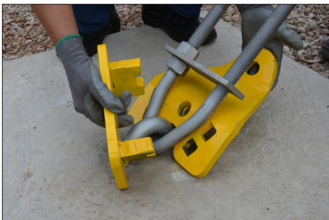
**3.** Encaixe a Base B do Dispositivo nos furos da Base A.
