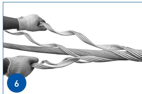
Finalize simultaneamente a aplicação dos subconjuntos de varetas, deixando faltar uma ou duas voltas para completar a aplicação.
