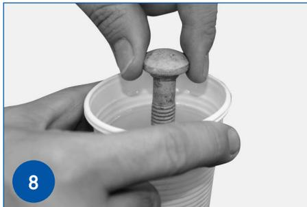
Mergulhe a rosca do parafuso em lubrificante líquido.
