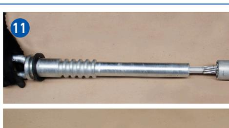
Deslize a haste até encostar na extremidade da luva de enchimento interno.
