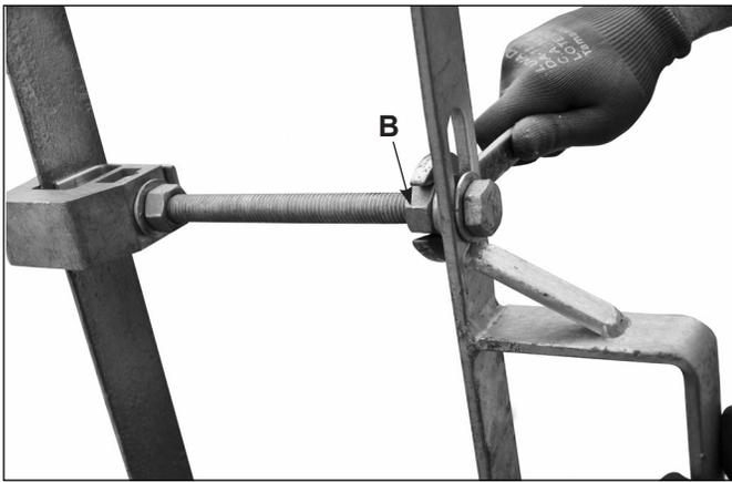
7. Finalize a instalação aplicando um torque de 2,0 kgf.m na Porca **B**.
