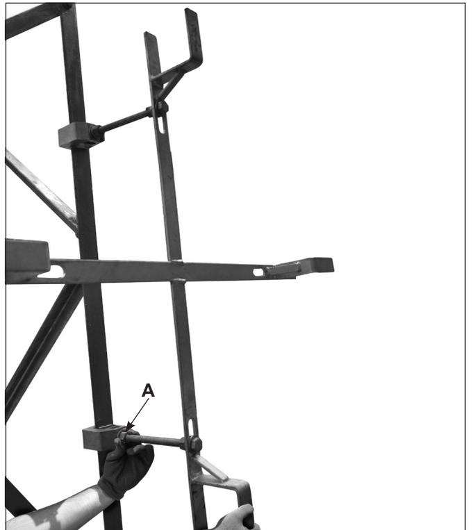
3. Posicione os Suportes de Fixação na estrutura da torre e rosqueie o Parafuso manualmente até que o Suporte fique preso à estrutura.
