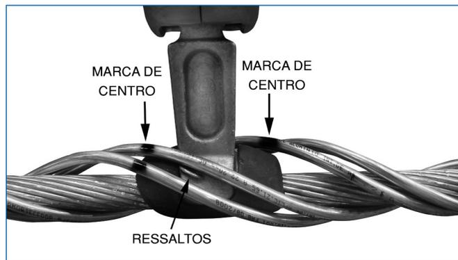
6. Para aplicar o próximo par de varetas no lado posterior da garra do Espaçador, repita as operações dos itens 3 a 5. Observe que as quatro varetas preformadas utilizadas para cada garra do Espaçador ficarão com as marcas de centro localizadas em extremidades opostas da garra.
