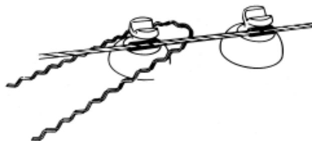
**2.** Introduza o Laço Lateral Duplo conforme indicado. Note que a perna do Laço que contém as marcas de início de aplicação é instalada no lado em que o condutor contata o isolador.
