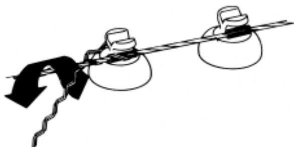
**3.** Aplique primeiramente essa perna do Laço que está ao lado do condutor. Depois faça coincidir a segunda perna com a marca colorida, aplicando-a em seguida.
