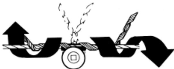
3. Coloque o condutor entre as pernas do laço de Roldana, puxe as pernas do laço em direções opostas e enrole-as sobre o condutor na mesma direção do encordoamento do condutor.
