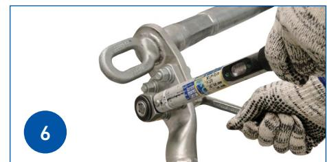
Com o auxílio de uma chave de boca e um toquímetro aplique o torque de 5,0 kgf.m.
