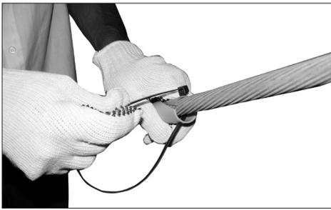
**5.** Aplique a abraçadeira plástica com a parte serrilhada voltada para o lado de dentro, passando pelos furos do Sinalizador e, então, introduza a extremidade da abraçadeira na trava.
