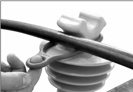
5.1 Posicione o Anel de Amarração e o Condutor lateralmente no pescoço do Isolador.
