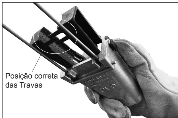
4. Empurre as Cunhas para fora do Grampo e certifique-se que as travas estejam posicionadas conforme mostra a foto.
