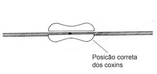
2. Sobre a marca indicada aplique os coxins fixan do as duas partes com uma camada de fita isolante.
