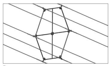
7. Espaçador Amortecedor Elíptico completamente aplicado.
