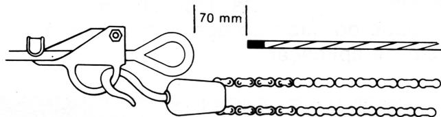
2. Aplique uma fita plástica isolante no cabo e corte-o a uma distância de cerca de 70 mm do olhal da âncora.
