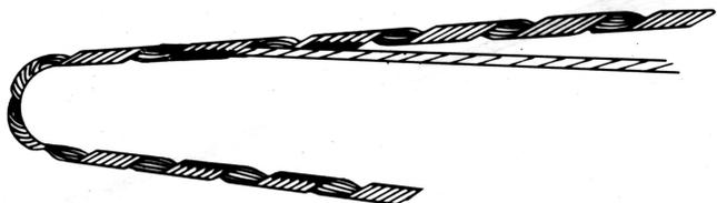
3. Posicione a ponta do cabo na marca colorida mais próxima da curva da Alça. Faça coincidir a curva da Alça com o olhal da âncora.
