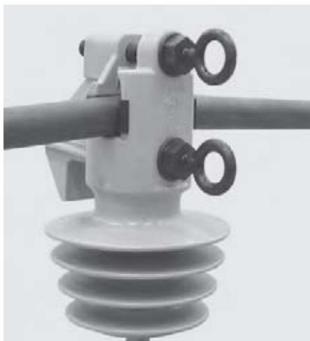
O Isolador Polimérico Vice-Top com garras da PLP é utilizado em Rede Aérea de de Distribuição de Energia Elétrica, classe de tensão de 15 kV ou 35 kV, para aplicação em cabos cobertos (pode ser aplicado também em cabos não cobertos, nessa caso, será necessário a troca dos mordentes de poliméricos para metálicos). O Isolador foi desenvolvido para atender aos parâmetros elétricos e mecânicos em ambientes típicos para esse tipo de rede.
