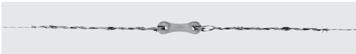
O Seccionador Preformado para Cerca - SCM destina-se ao seccionamento elétrico de arame farpado ou arame liso, nas cercas que correm paralelamente ou são transpostas pelas linhas de transmissão ou distribuição de energia elétrica.
