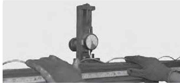
Durante a produção é feito um exame por amostragem para controle dimensional. O processo de fabricação das varetas é autoseletivo, ou seja, qualquer anormalidade na composição e propriedades mecânicas do vergalhão ou fio reflete-se nas dimensões da hélice e resulta na impossibilidade de “casamento” entre as varetas, fato este forçosamente notado durante o processo de produção.
