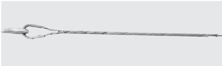
A Alça Preformada para Cabo de Aço - GDE destina-se à ancoragem de cabos de aço galvanizados e cabos de aço revestidos de alumínio, respectivamente, sujeitos a esforços de tração sem torção. Dependendo do caso, deve ser usada juntamente com sapatilha ou manilha sapatilha.
