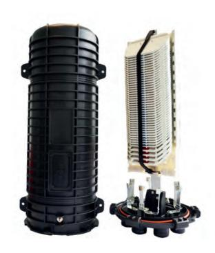
A Caixa de Emenda FibreGuard 8" possui sistema de gerenciamento individual para as fibras ópticas, apresenta capacidade para até 288 fibras, com bandejas de circuito simples com até 6 fibras/bandejas e bandejas de elemento simples até 12 fibras/bandeja, fabricado em material polimérico, resistente a intempéries, totalmente mecânica. Permite instalação em redes aéreas, subterrâneas e/ou redes enterradas.
