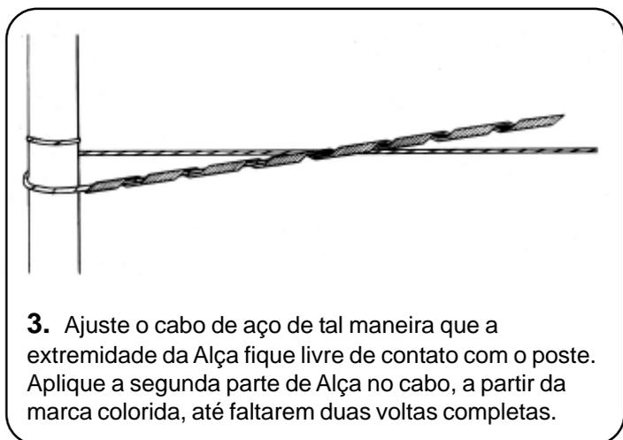
**3.** Ajuste o cabo de aço de tal maneira que a extremidade da Alça fique livre de contato com o poste. Aplique a segunda parte de Alça no cabo, a partir da marca colorida, até faltarem duas voltas completas.
