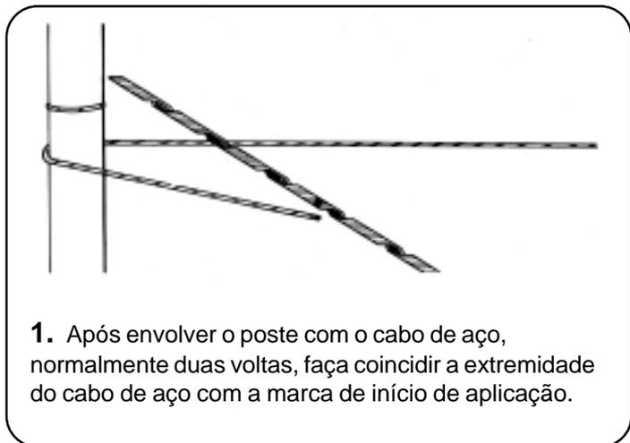
**1.** Após envolver o poste com o cabo de aço, normalmente duas voltas, faça coincidir a extremidade do cabo de aço com a marca de início de aplicação.
