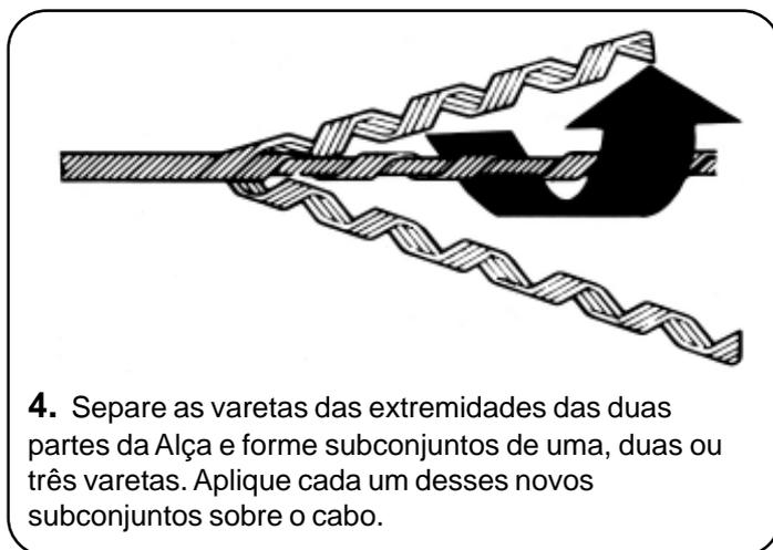
**4.** Separe as varetas das extremidades das duas partes da Alça e forme subconjuntos de uma, duas ou três varetas. Aplique cada um desses novos subconjuntos sobre o cabo.
