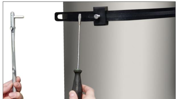
Chave de fenda ou ferramenta semelhante para usar como alavanca no tensionamento da cinta.
