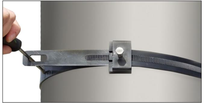
3. Tensione a cinta com uma chave de fenda ou uma ferramenta semelhante posicionada através do orifício até atingir o limite máximo das ranhuras.
