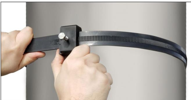
1. Passe a extremidade da cinta pela fivela e faça o tensionamento manual.
