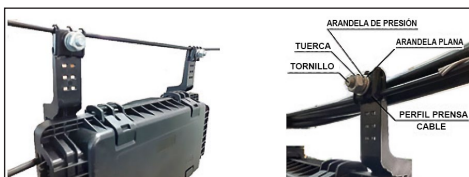
4.5.2 Para fijación en el cable de acero, utilice el conjunto de perfil de prensacable y los componentes metálicos (tornillo, arandelas y tuerca).
