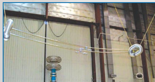
Teste Elétrico de Corona do Amortecedor VORTX
