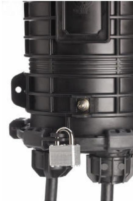
La caja se cierra manualmente, sin herramientas, girando la cubierta superior sobre la base de entrada hasta activar el sistema Locking Cover, permitiendo además utilizar un candado para asegurar el cierre. La apertura de la caja se realiza de manera muy sencilla, en un tiempo no mayor de 10 segundos, manteniéndose la estanqueidad después de cada reapertura.
