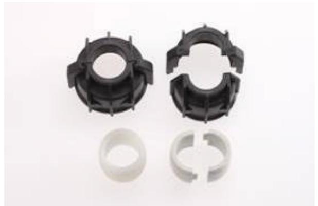
La caja de empalme FIBREGUARD™ dispone de un puerto oval que permite hacer instalaciones para cable no cortado, tanto las tuercas como los grommets y los elementos de guiado se pueden dividir en 2 mitades, permitiendo las instalaciones de cable en sangría o en tránsito.
