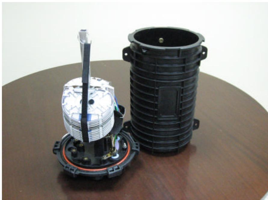
La caja FIBREGUARD™ está diseñada para alojar cualquier tipo de cable: monotubo, fibra holgada, cable buffer, ribbon, ADSS, OPGW y subterráneo, haciendo a la caja altamente versátil.
