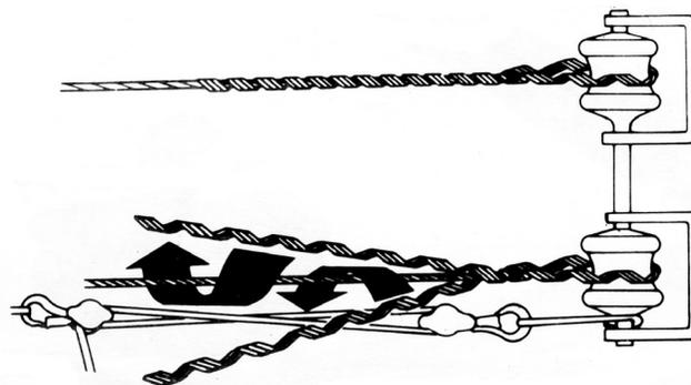
4. Tracione o segundo condutor com a tração ligeiramente superior à do primeiro e aplique sobre o condutor ambas as pernas da Alça até uma ou duas voltas, conforme indicado. Para igualar a tensão, solte aos poucos o condutor, que ele deslizará sob a Alça. Complete a aplicação da Alça sobre o condutor.
