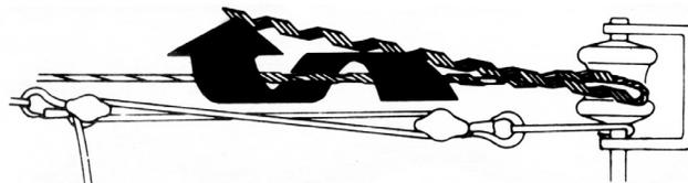
2. A partir da marca de início de aplicação, aplique uma das pernas da Alça Preformada sobre o condutor.
