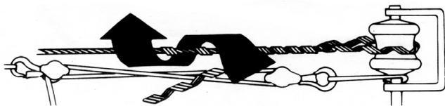
3. Introduza a segunda perna da Alça envolvendo a roldana e aplique-a sobre o cabo, fazendo coincidir as marcas coloridas de início da aplicação.
