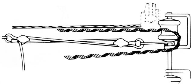
1. Tracione o condutor e corte-o a uma distância de aproximadamente uma mão do isolador. Faça coincidir a curva da Alça com a ranhura do isolador.
