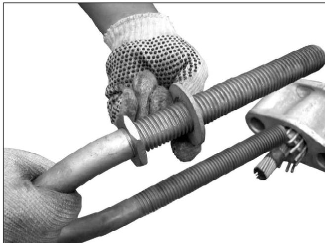
**10.** Enrosque la Tuerca de Traba (la de menor espesor) en una de las piernas de la Grapa "V" hasta el final de la rosca e inserte la Arandela.
