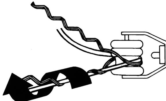
**3.** A partir da marca de início de aplicação, aplique uma das pernas da Alça Preformada sobre o fio.
