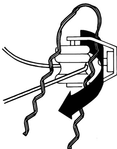
**2.** Tracione o fio e corte-o a uma distância de aproximadamente uma mão do acessório de ancoragem (isolador ou parafuso olhal + sapatilha). Introduza a Alça no acessório de ancoragem.
