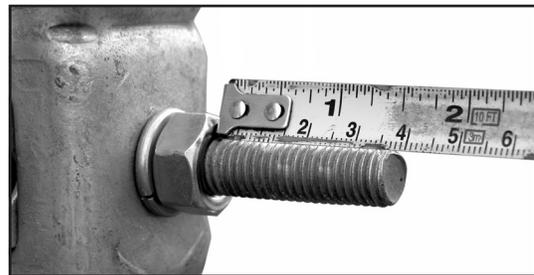
Foto 2 – Medindo o comprimento da Rosca.
