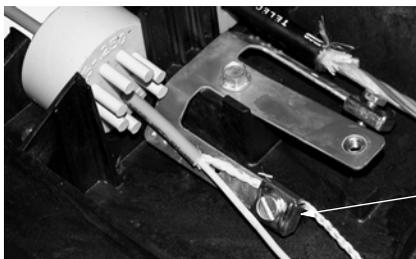
Enrole os fios de aramida no parafuso por baixo do capuz. Aperte o parafuso e corte o excedente de fios.
