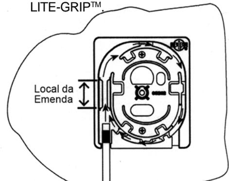
**Passo 5** Emende a fibra do Cabo Drop na fibra do Pigtail e acomode o Pigtail no canal interno do estojo .
