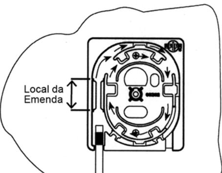
**Passo 6** Encaixe o Protetor de Emenda no centro de fendas do LITE-GRIP™ e posicione-o no local da emenda, entre as nervuras do estojo.
