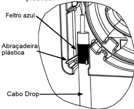
**Passo 4** Direcione a fibra nua em volta do canal externo do estojo até a posição de encaixe no LITE-GRIP™.
