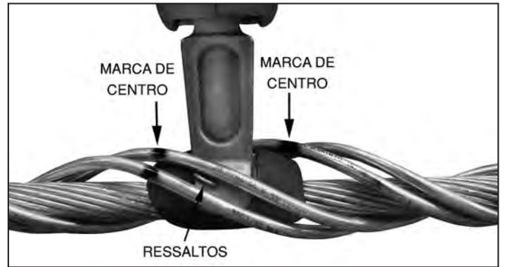
6. Para aplicar o próximo par de varetas no lado posterior da garra do Espaçador, repita as operações dos itens 3 a 5. Observe que as quatro varetas preformadas utilizadas para cada garra do Espaçador ficarão com as marcas de centro localizadas em extremidades opostas da garra.
