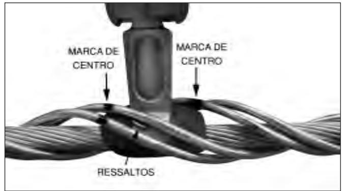
6. Para aplicar o próximo par de varetas no lado posterior da garra do Espaçador, repita as operações dos itens 3 a 5. Observe que as quatro varetas preformadas utilizadas para cada garra do Espaçador ficarão com as marcas de centro localizadas em extremidades opostas da garra.
