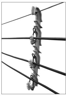
**2.2** Posicione o Separador com os Anéis sobre o cabo mensageiro e encaixe os condutores revestidos sobre as garras.
