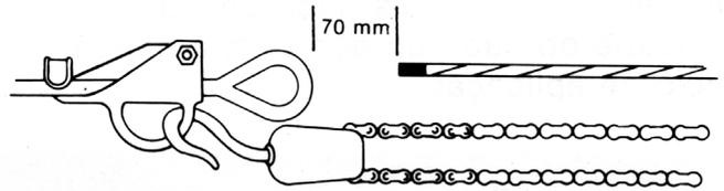
2. Aplique uma fita plástica isolante no cabo e corte-o a uma distância de cerca de 70 mm do olhal da âncora.
