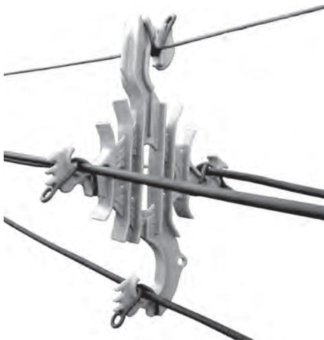
Acessório de formato losangular para utilização em Redes Compactas, classe de tensão 35 kV. Apoiado sobre um cabo mensageiro, sua função é a sustentação e separação dos cabos cobertos ao longo do vão, mantendo o isolamento elétrico da rede.
