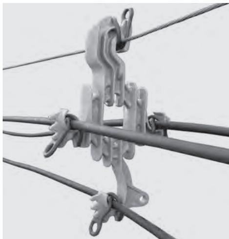
Acessório de formato losangular para utilização em Redes Compactas, classe de tensão 15 kV. Apoiado sobre um cabo mensageiro, sua função é a sustentação e separação dos cabos cobertos ao longo do vão, mantendo o isolamento elétrico da rede.
