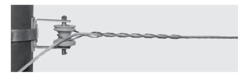
A Alça Preformada de Serviço - SG destina-se à ancoragem dos cabos ou fios de alumínio nus ou revestidos em entradas de consumidor ou ainda à fixação do neutro do cabo multiplexado usado em ramais de serviço.
